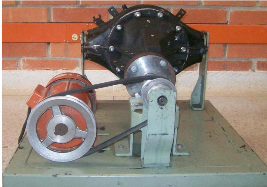
**Figura 3: Banco de Pruebas para toma de datos en transmisión diferencial**
