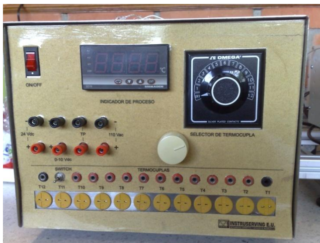
Figura 50. Modulo de adquisición de temperatura IntechMicro 2100-A16 RS232.
