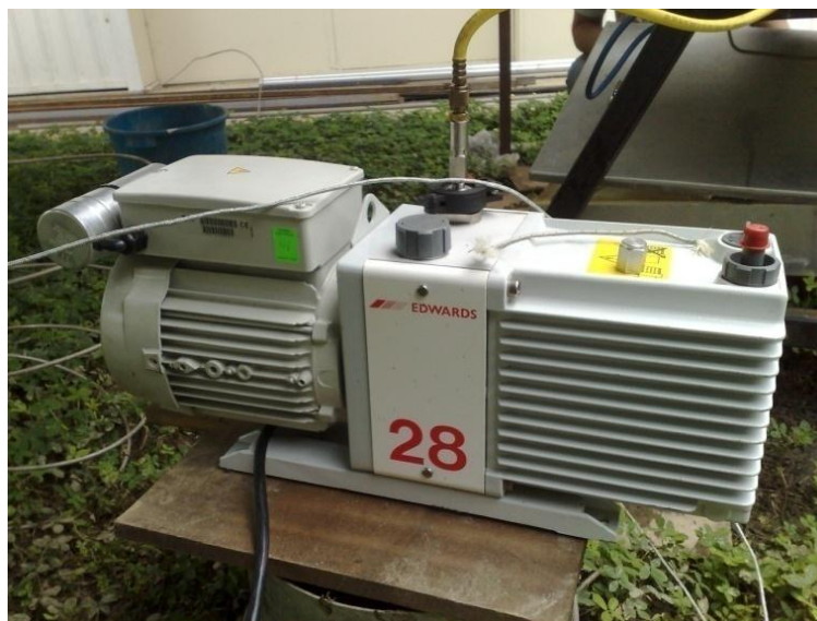
Figura 53. Bomba de marca Edwards E2M28.
