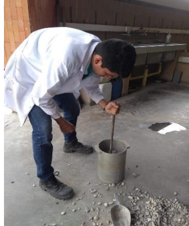
Ilustración 25 Ensayo de determinación de la masa unitaria en agregados
