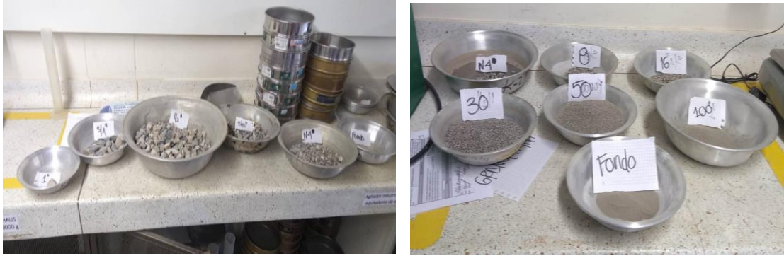
Ilustración 23 Ensayo granulometría agregado grueso y fino
