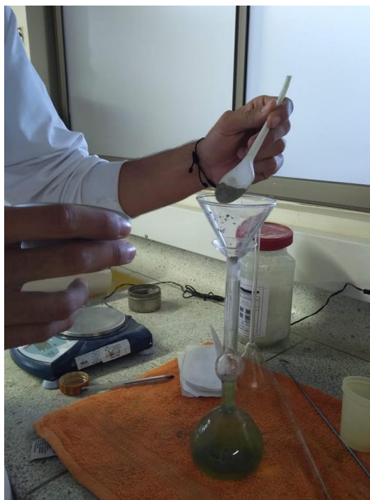
Ilustración 22 Ensayo densidad del cemento hidráulico
