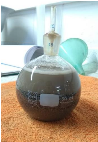
Ilustración 26 Ensayo peso específico y absorción de agregados
