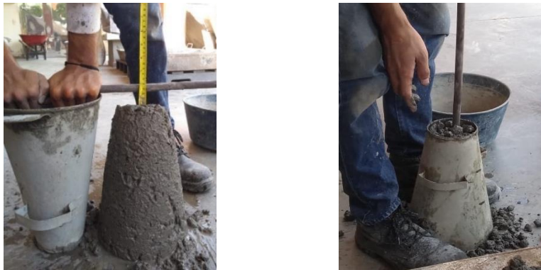
Ilustración 56 Ensayo de Asentamiento del concreto
