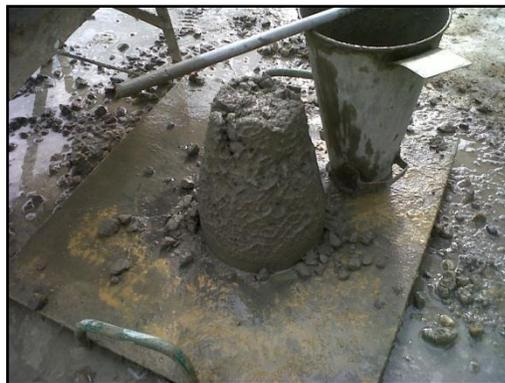
**Foto 63. Slump para concreto.**
