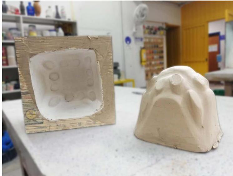
Fig. 17. Molde de yeso para la producción seriada de la morfología, y, piezas cerámicas resultante en el proceso de su producción para un producto industrial. Fuente: autor
