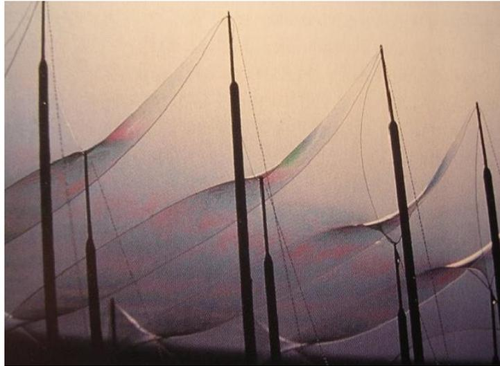
Fig 2. Experimentación con burbujas de Frei Otto para el estudio de superficies. Tomado de: [shorturl.at/gGMQ8](http://shorturl.at/gGMQ8), el 22/06/2019.
