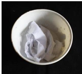
Fig. 5b. Se impregna el textil con la mezcla. Fuente: autor.
