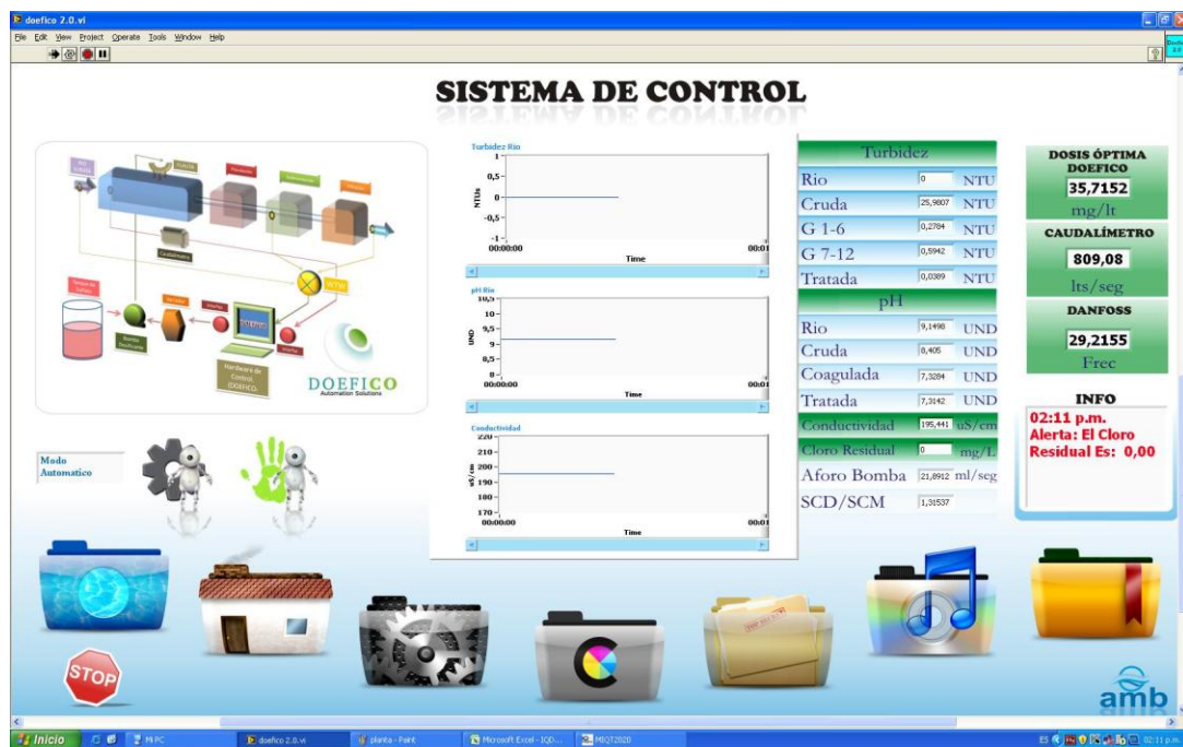
Figura No. 13 Pestaña “Sistema de Control” DOEFICO v2.0
