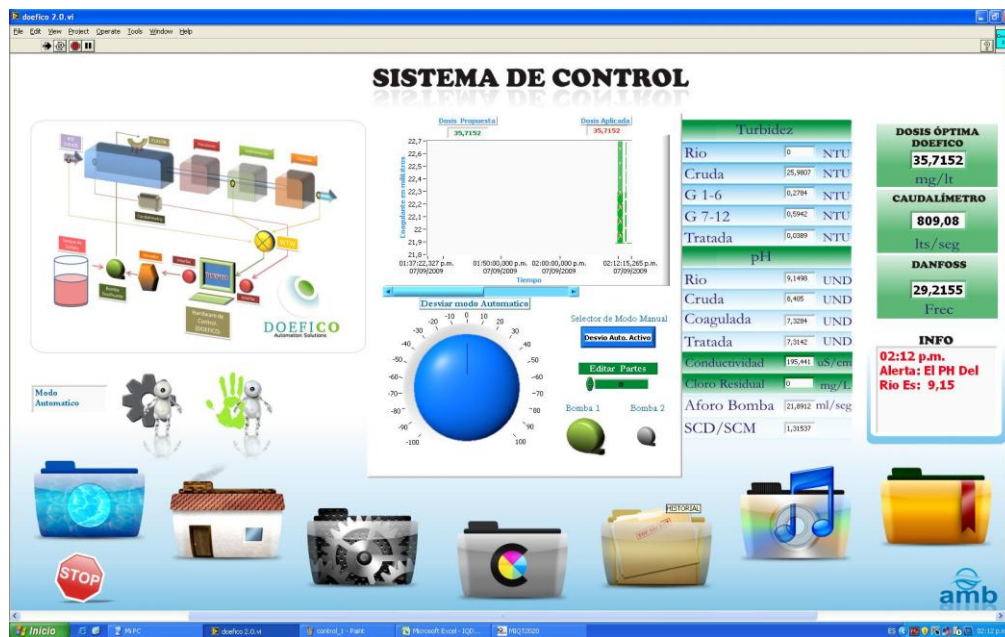
Figura No. 14 Pestaña “Sistema de Control” DOEFICO v2.0
