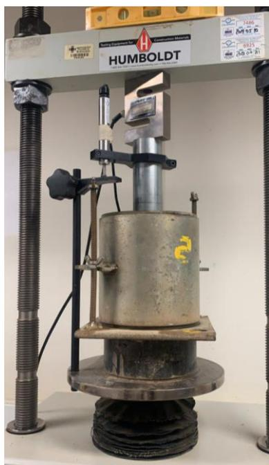
**Figura 8. Ensayo de CBR.**
