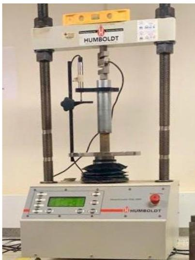
**Figura 6. Ensayo de compresión simple.**
