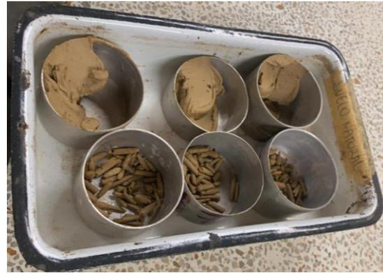
**Figura 3. Ensayo de límites de Atterberg**
