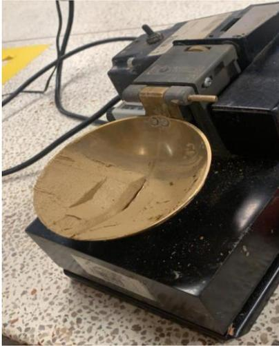
**Figura 4. Muestras ensayo límite líquido y plástico**
