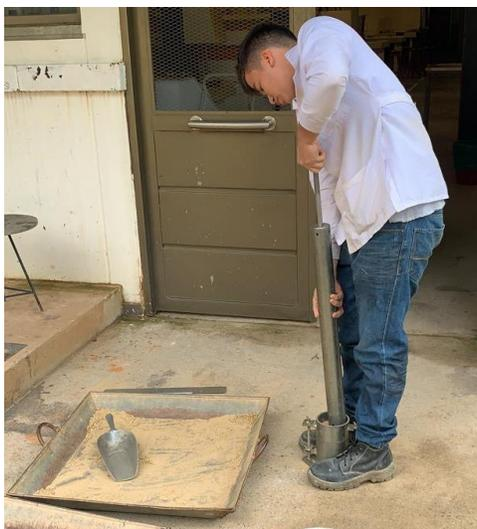
**Figura 5. Ensayo Proctor modificado**
