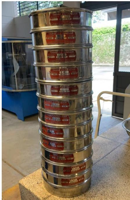
**Figura 2. Ensayo de Granulometría.**
