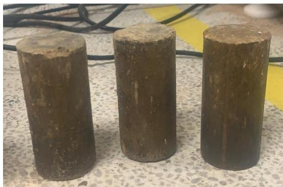
**Figura 7. Muestras compresión simple.**
