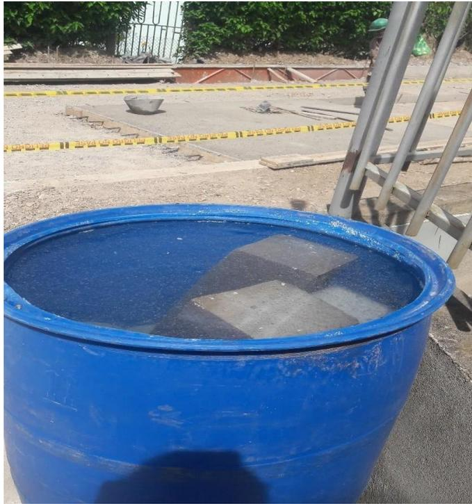
*Imagen 40 Curado de Cilindros y Viguetas*
