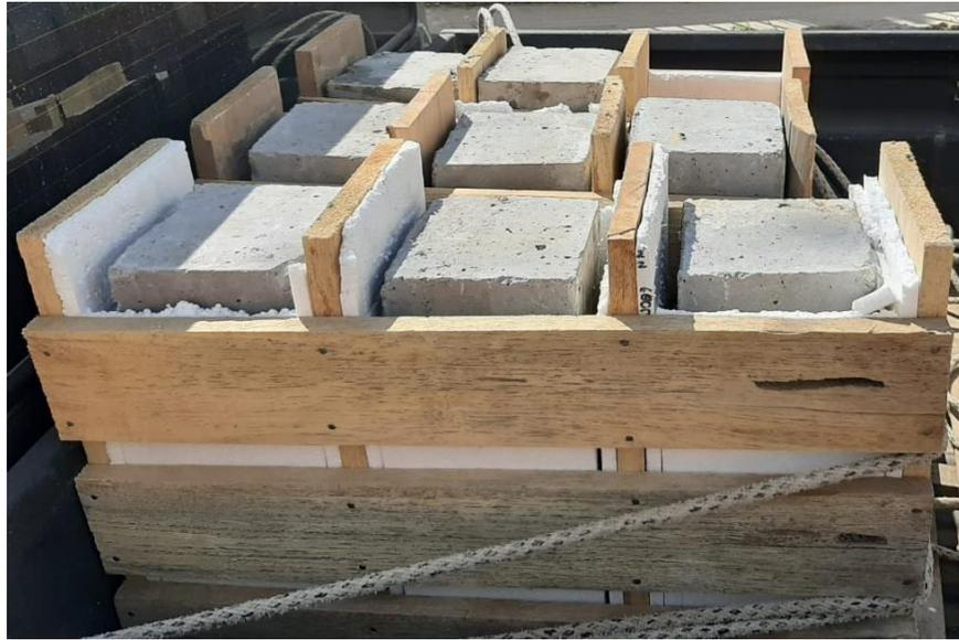
*Imagen 36 Transporte de Muestras a el laboratorio*
