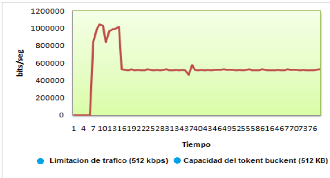
Figura 6. Comportamiento del ancho con la configuración de los valores máximos del token bucket
