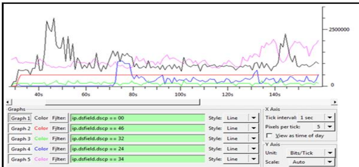
Figura 51. Tráfico de diferentes clases de servicios.
