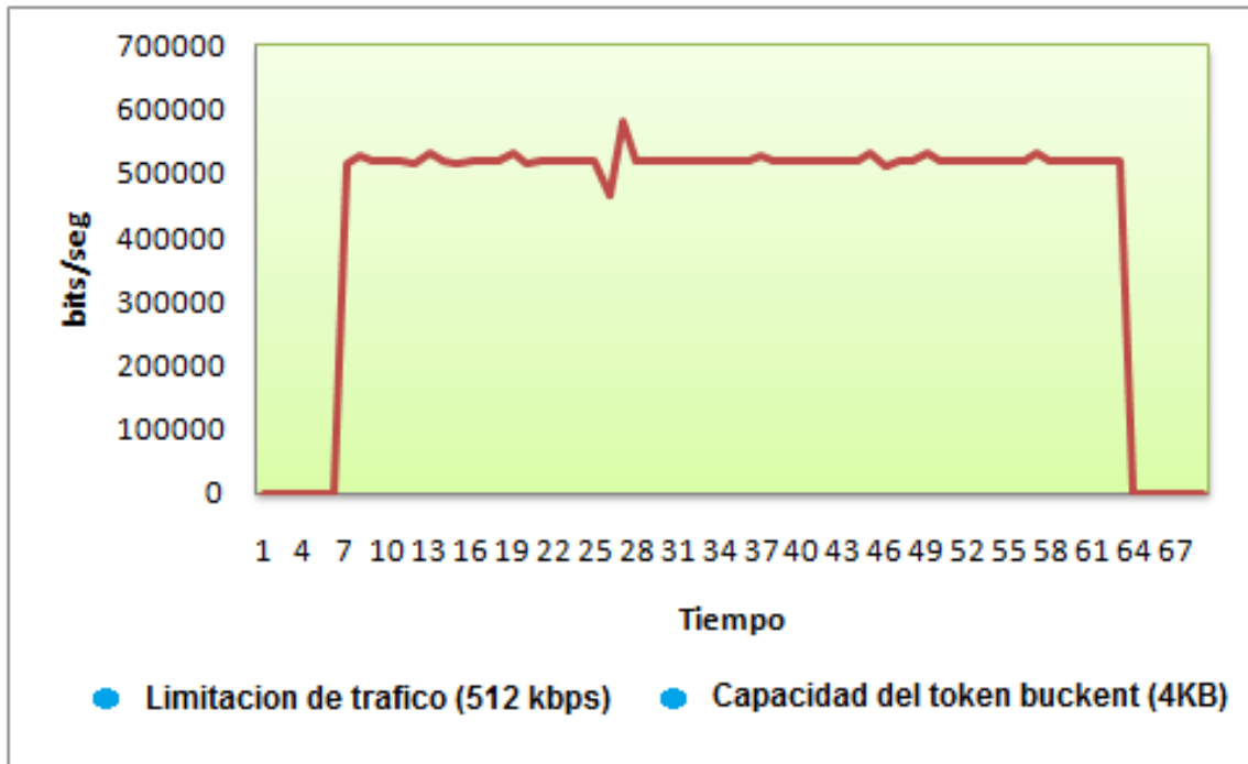
Figura 40. Transmisión de un video utilizando el método recortador de tráfico con el token bucket a su mínima capacidad
