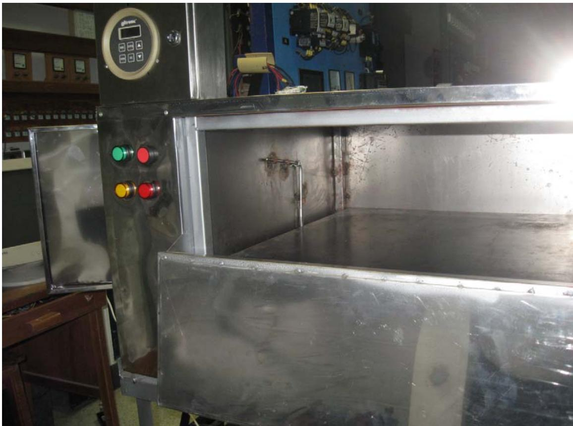
Figura 3. Verificar la conexión del sensor de temperatura dentro del horno.
