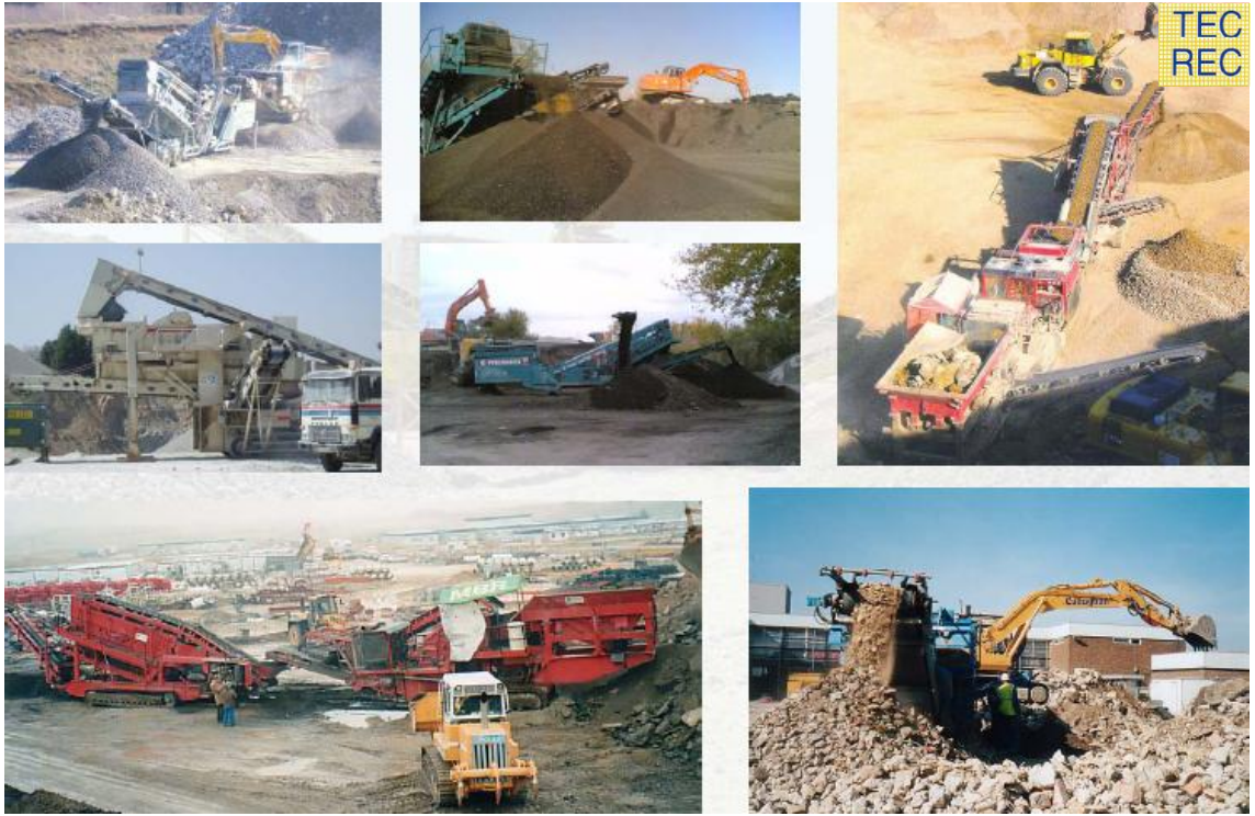
Plantas Tratamiento de escombros, diferentes procesos de producción tomada de la Cartilla de Jose Ignacio Tertre Toran
