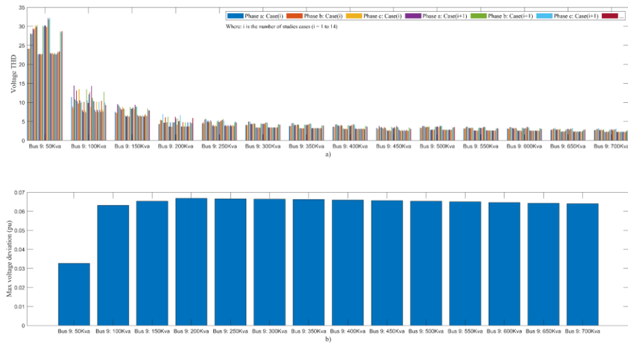
Figura 39. (a) THD por barra en máxima demanda con compensación en barra 9 y (b) Desviación máxima de voltaje con compensación en barra 9 sin considerar el THD como criterio objetivo.
