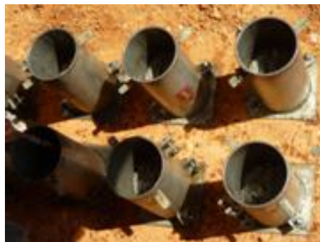
Fig. 92 Inicio de toma de muestra de concreto
