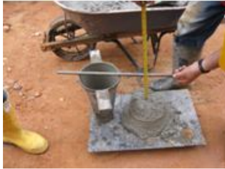
Fig. 90 Asentamiento de 5 \frac{3}{4} ". OK
