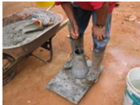
Fig. 86 Chuzada de 1ra capa concreto
