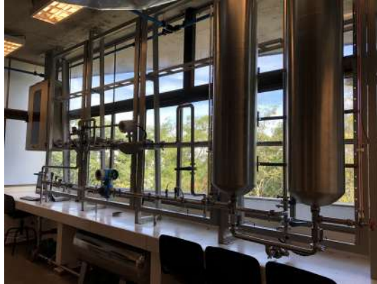
Figura 20: Módulo del banco de flujo. Fuente Autor.
