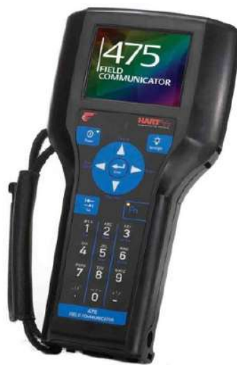
Figura 8: Comunicador portátil HART. Imagen tomada de 6
