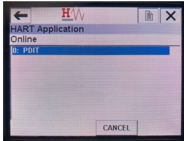
Figura 29: Reconocimiento del transmisor LD301 en el comunicador de campo Rosemount 475. Fuente autor.
