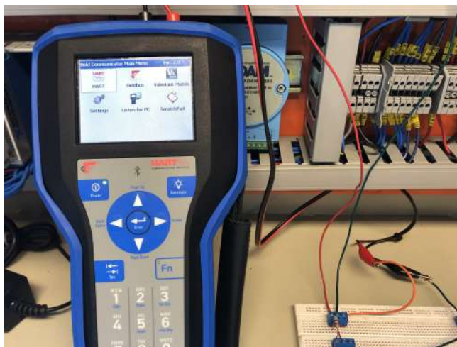
Figura 47: Conexión del comunicador de campo Rosemount a la salida HART del transmisor Promag 50. Fuente autor.
