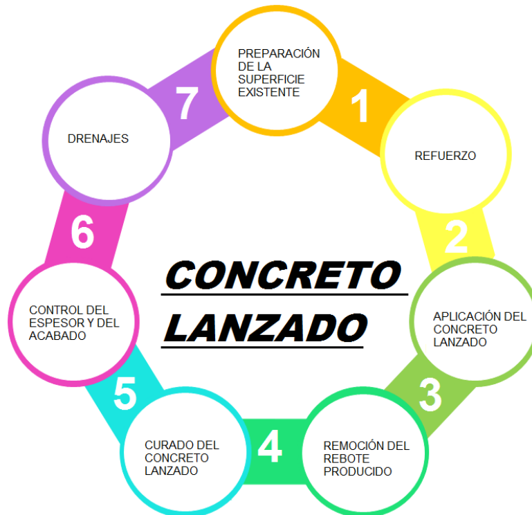
Figura 6. Instalación del Concreto Lanzado
