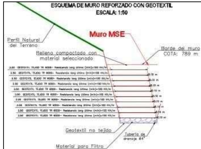
Ilustración 50. Detalle constructivo de la sección transversal tipo del Muro La Pradera - Girón
