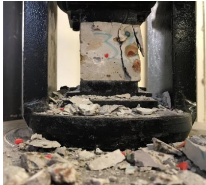
Ilustración 21. Mortero sometido a compresión
