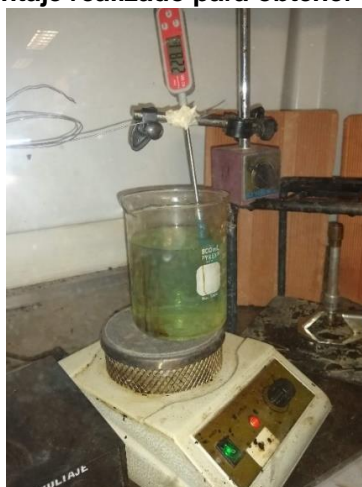
Ilustración 16. Montaje realizado para obtener el punto de Fusión
