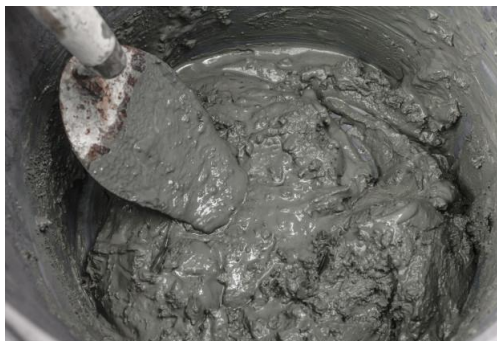
Ilustración 1. Mezcla para mortero hidráulico
