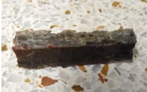
Ilustración 17. Probeta para ensayo de Charpy
