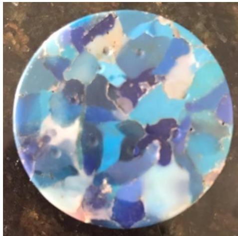
Ilustración 19. Probeta ensayo de Dureza
