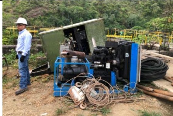
Fotografía 3. Daño de maquinaria de perforación Fuente: Propia – amb S.A. E.S.P.
