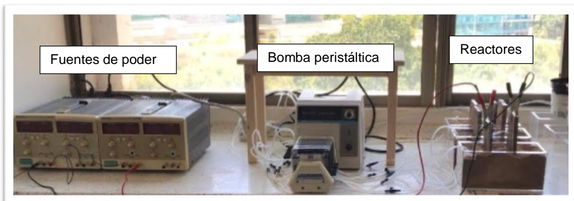
Figura 11. Prototipo de electroremediación
