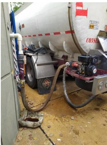
*Ilustración 9. Descarga Coagulante líquido.*
