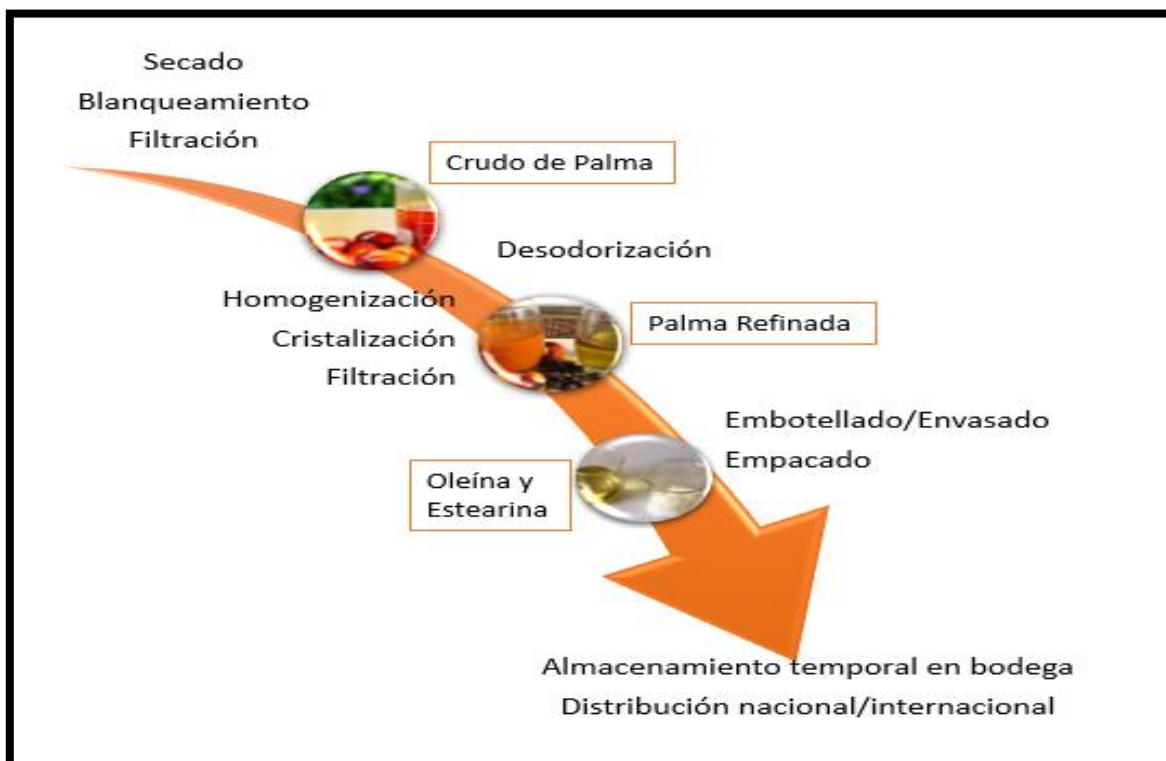
Figura 2. Proceso producción aceites de palma.
