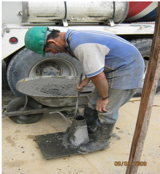
Foto No. 38. Toma muestras en el proceso del ensayo de asentamiento (Cono de Abrams).
