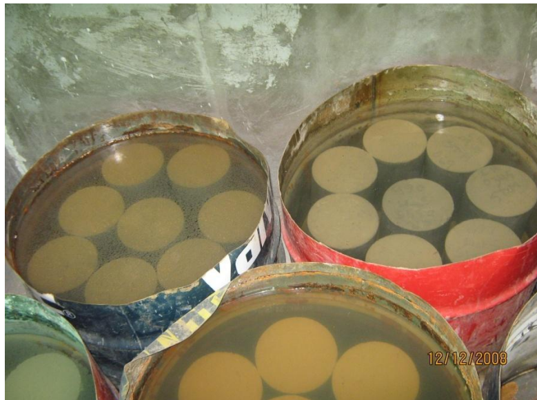
Foto 43. Curado de muestras de concreto en canecas metálicas.
