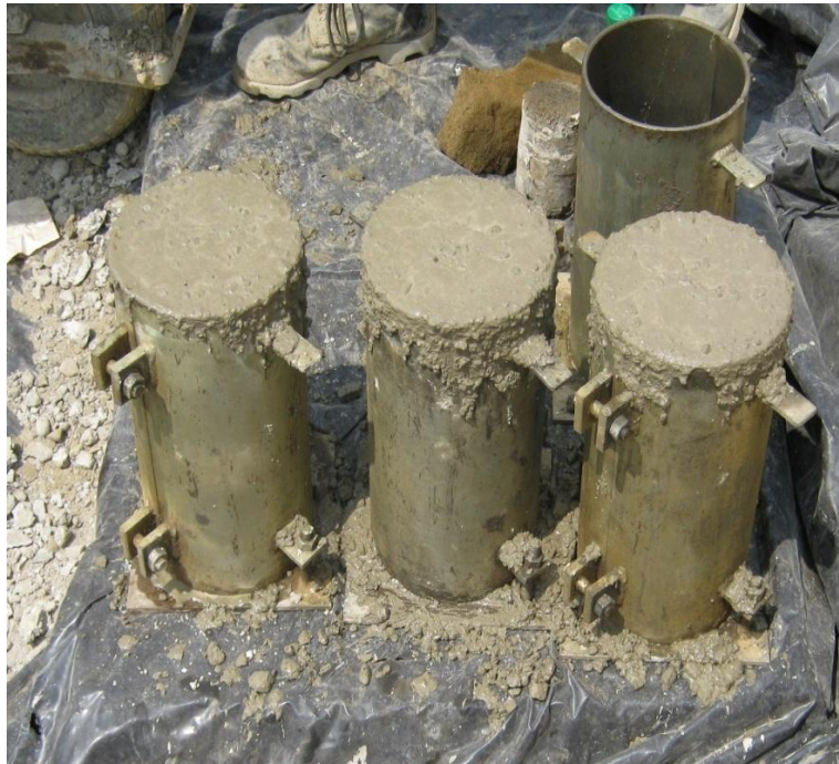
Foto 41. Muestra de concreto fresco.
