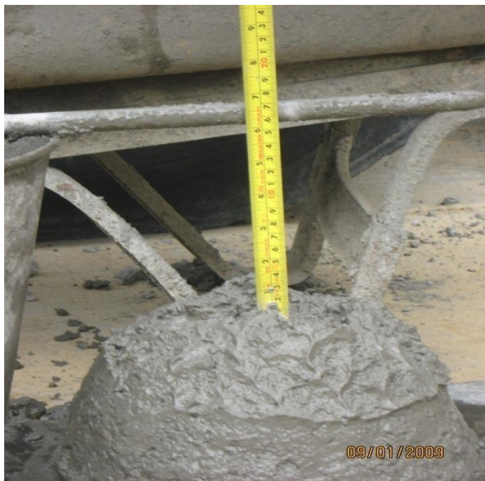
Foto 39. Resultado del ensayo de asentamiento, especificación 6”.
