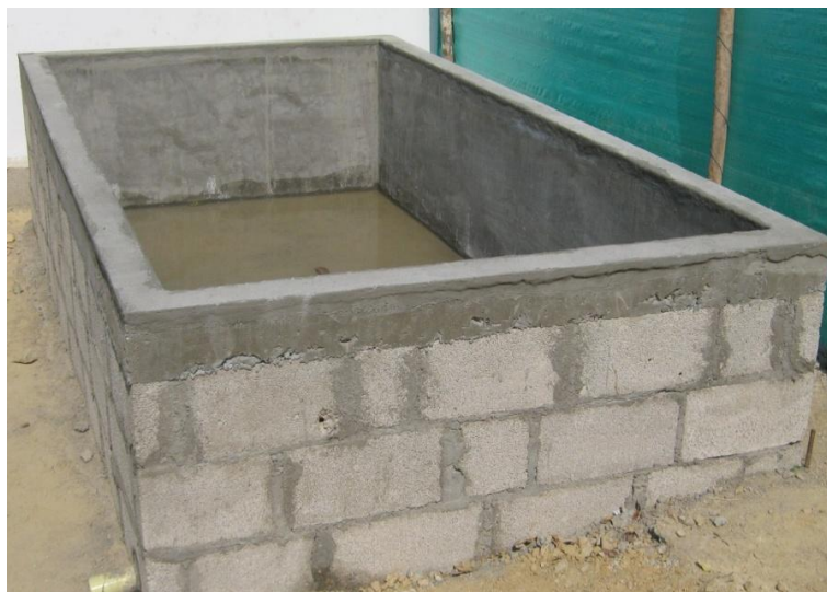
Foto No. 44. Pila de curado de cilindros en concreto.
