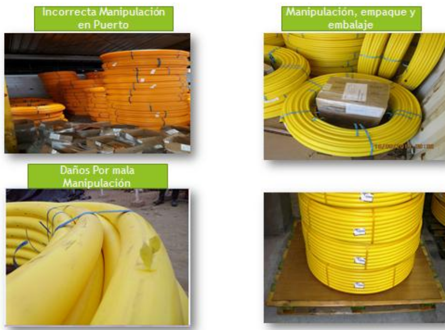
Figura 12. Correcta e Incorrecta Manipulación de la Tubería PE. Por Colombiana de Extrusión (2019)
