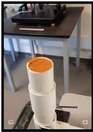
Ilustración 17. Cilindro de muestra de suelo saturado
