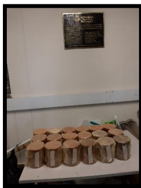
Ilustración 25. Muestras para ensayo de lixiviación
