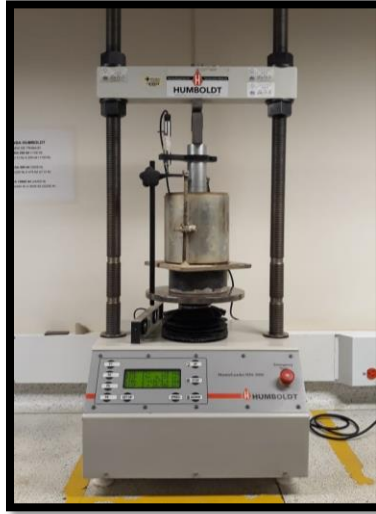
Ilustración 14. Molde sometido a una carga mediante mecanismo correspondiente de la prensa.
