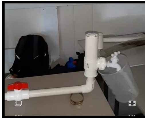
Ilustración 16. Modelo de permeámetro nivelado en sus extremos.
