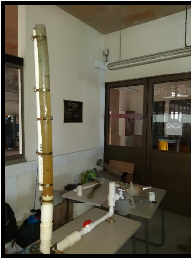
Ilustración 18. Ensayo permeámetro en ejecución
