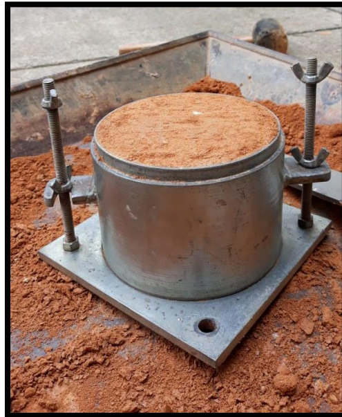
Ilustración 10. Muestra compactada - ensayo Proctor modificado
