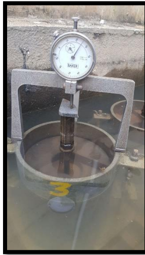
Ilustración 13. Molde en inmersión - ensayo CBR
