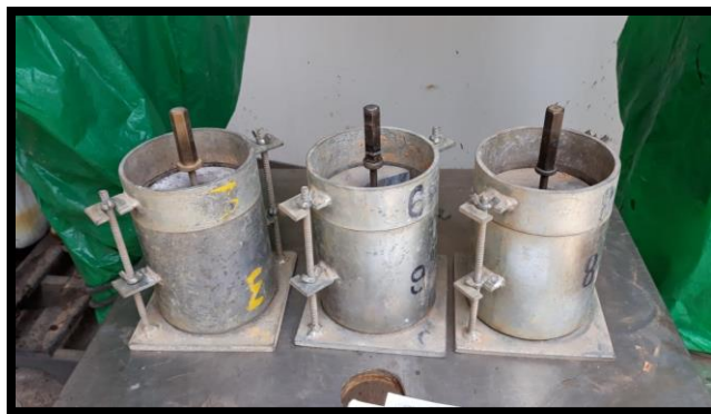
Ilustración 12. Moldes de CBR.
