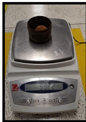
Ilustración 11. Muestra de suelo + capsula - ensayo Proctor modificado
