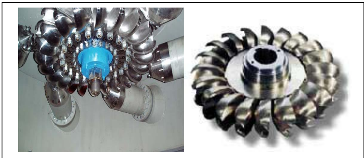
Figura 4. Detalle de inyectores y rodete Pelton
