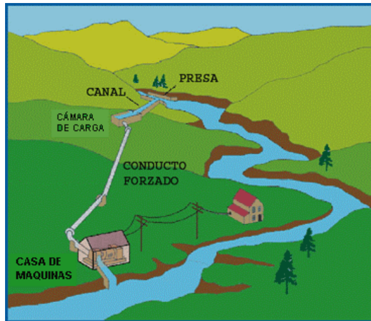
Figura 1. Esquema general de una MCH
