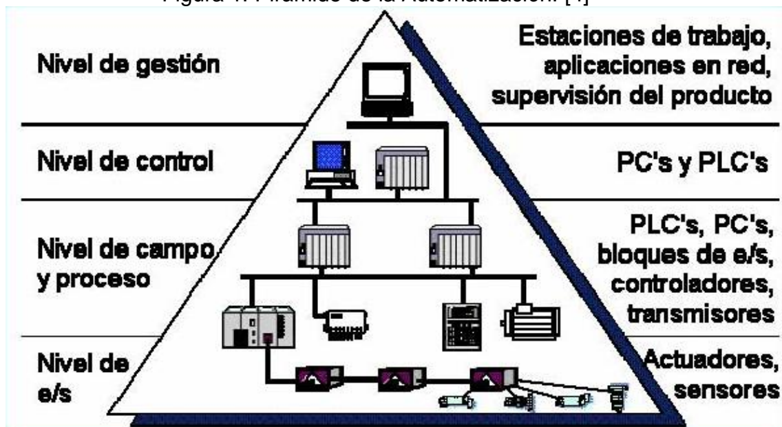
Figura 1. Pirámide de la Automatización. [4]
