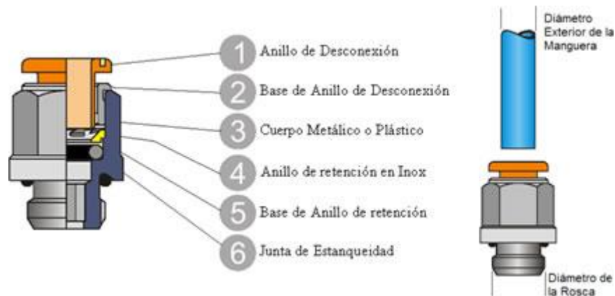
Figura 37. Características técnicas de un racor. [39]
