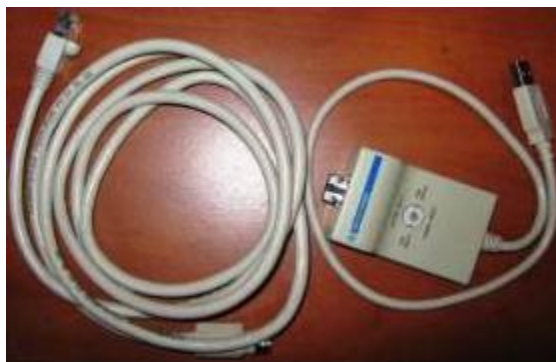
Figura 55. Cable multimaestro TSXCUSB485. Fuente autor.
