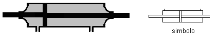
Figura 18. Cilindro vástago reforzado y su símbolo. [14]
