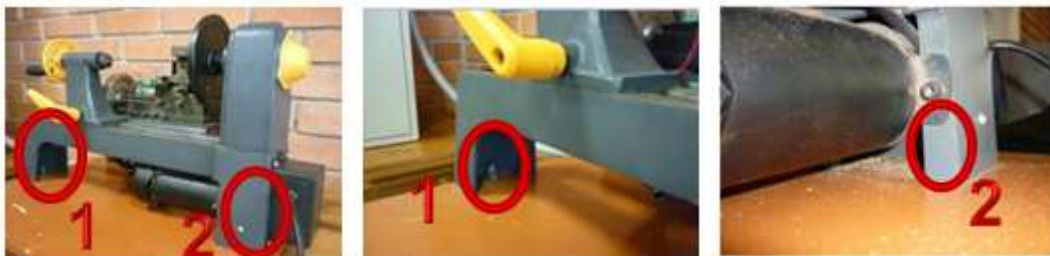
Figura 2: Ubicación de tornillos de la estructura
