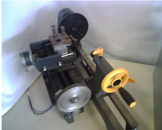
Figura 13. Estructura final del Torno y sus acoples. [31]
