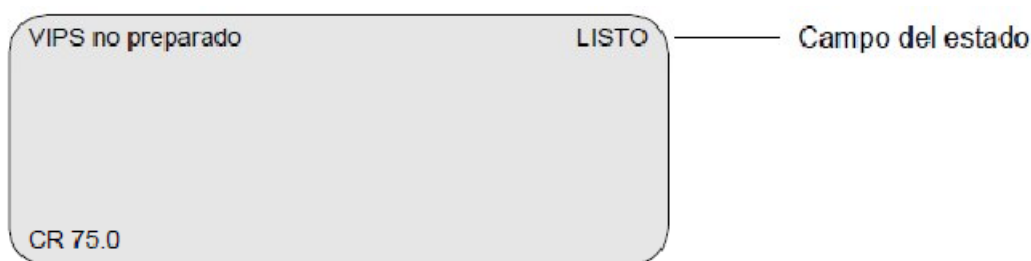
Figura 7. Pantalla de visualización del CR 75.0 (Fuente: Manual de uso de Agfa CR75)
