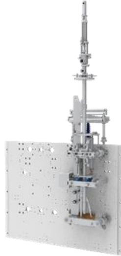
*Figura 20. Sistema de dosificación, conformador de plástico, sello horizontal, sella vertical desaireador.*
