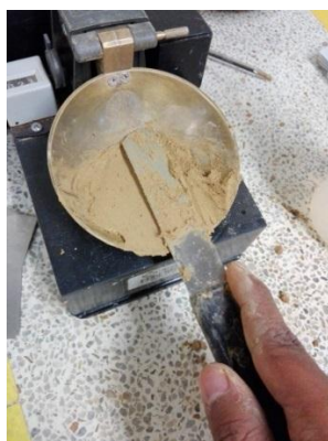
Ilustración 22. Aplicación de la pasta a la Casagrande.
