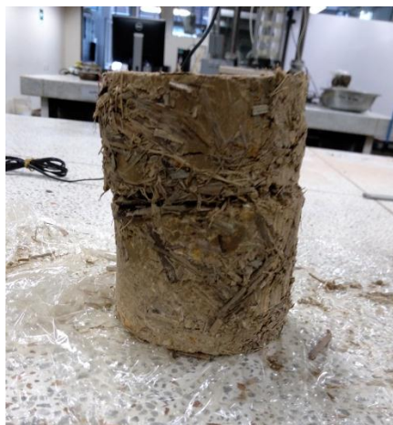
Ilustración 33. Espécimen dañado por exceso de biomasa.
