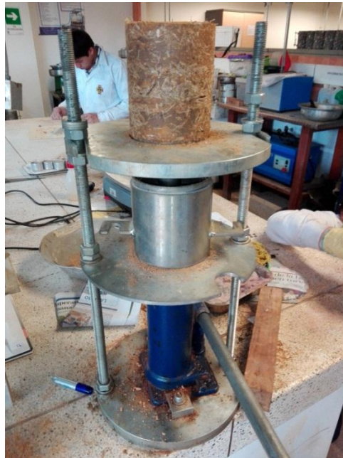
Ilustración 29. Desencofrado de un espécimen.
