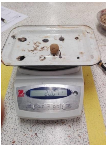
Ilustración 23. Bola de 2 gramos para ensayo de límite plástico e índice de plasticidad.
