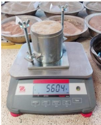
Ilustración 26. Pesado del cilindro compactado.
