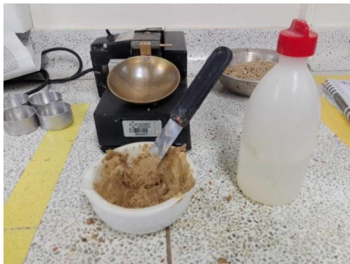
Ilustración 21. Pasta en estado de humedad para aplicarse a la cazuela.
