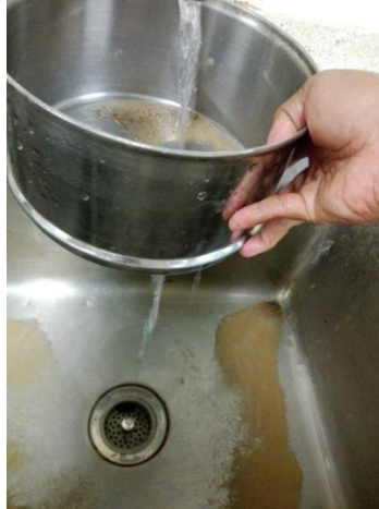
Ilustración 19. Lavado del suelo en el tamiz 200.
