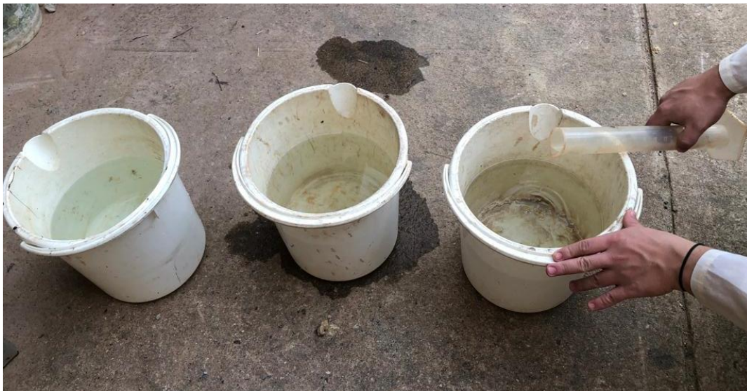
Fotografía 16 Adición del estabilizante BioCEC
