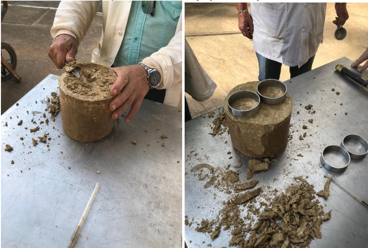
Fotografía 14 Corte Directo preparación espécimen
