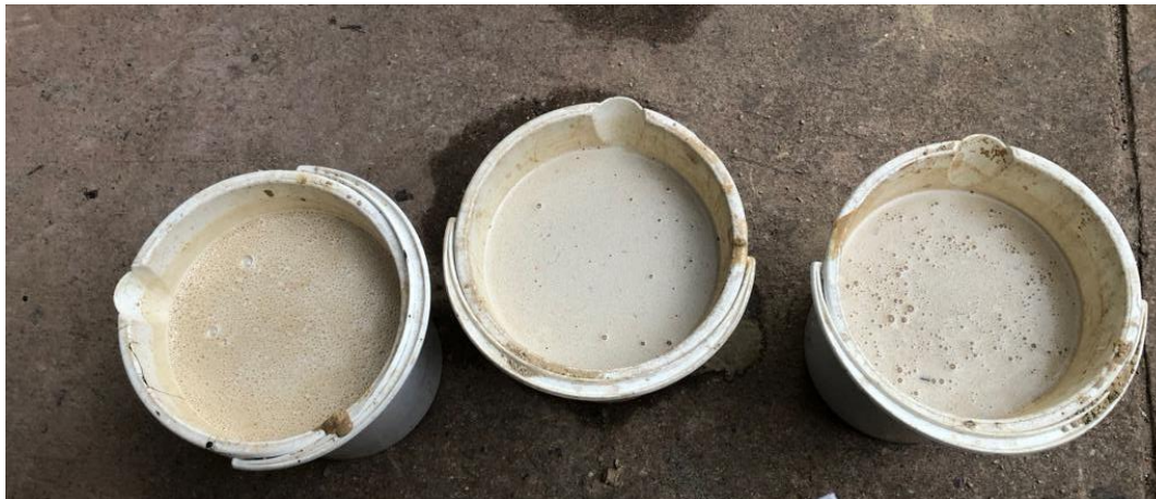
Fotografía 19 Decantación del suelo más solución
