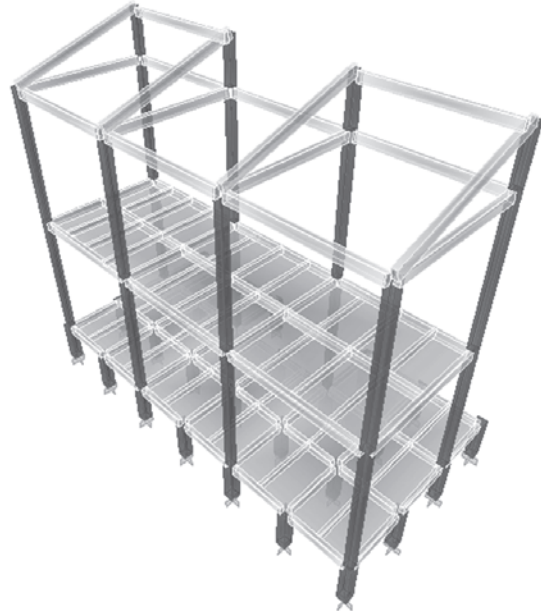
Fig. 3 Modelo estructural módulo compuesto Fuente: Elaboración propia
