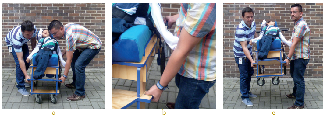
Fig. 9a. Inicio del proceso de levantamiento del sistema. Fig. 9b. Zonas de agarre lateral del sistema. Fig. 9c. Sistema levantado. Fuente: archivo Grupo de Investigación de Estudios en Diseño -GED- de la Facultad de Diseño Industrial de la Universidad Pontificia Bolivariana.
