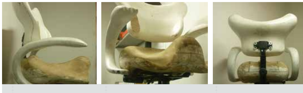
Figura 11. Piezas de la silla maquinadas por control numérico. Fuente propia.
