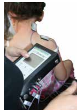
Figura 7. Electrodo de superficie que midieron los músculos de tronco y cabeza para validar la postura en el prototipo silla. Fuente propia.
