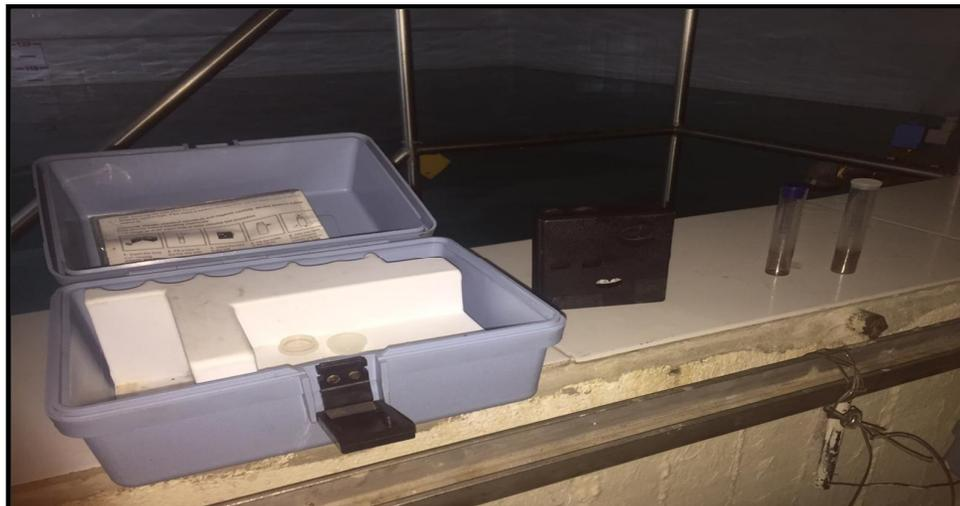
En la imagen 5 se muestra el kit de prueba de cloro utilizado, el HACH modelo CN67, el cual sirve para el control del cloro y el pH manteniendo la condición higiénica de las aguas y protegiendo el sistema frente a la corrosión. Se suministra con discos de color y un comparador para supervisar el cloro y el pH; el test kit de cloro libre y total y de pH ofrece mayor precisión que los test kits que utilizan cubetas de color o comparadores escalonados.
