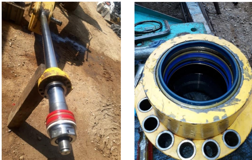
Figura 40. Cilindro de excavadora kobelco SK210 con empaquetadura nueva y listo para ser armado.
