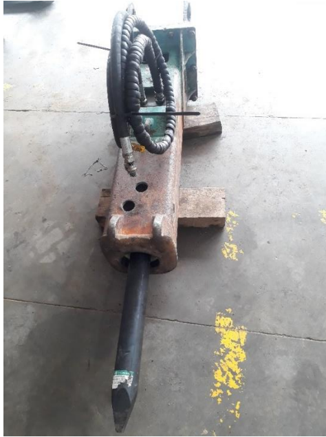
Figura 36. Martillo EHB06 reparado, listo para realizar pruebas y ajuste de calibración de nitrógeno.
