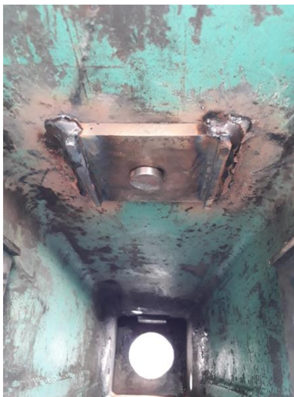
Figura 35. Pieza soldada a la carcasa del martillo EHB06
