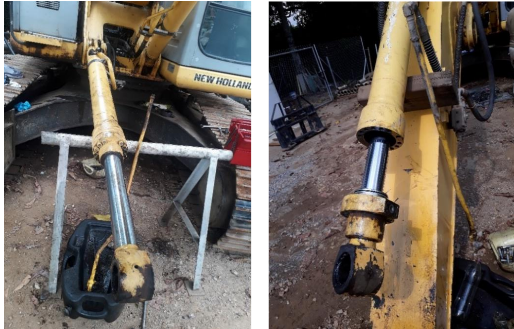
Figura 33. Cilindro gemelo de excavadora New Holland en proceso de desarme para cambio de empaquetadura.
