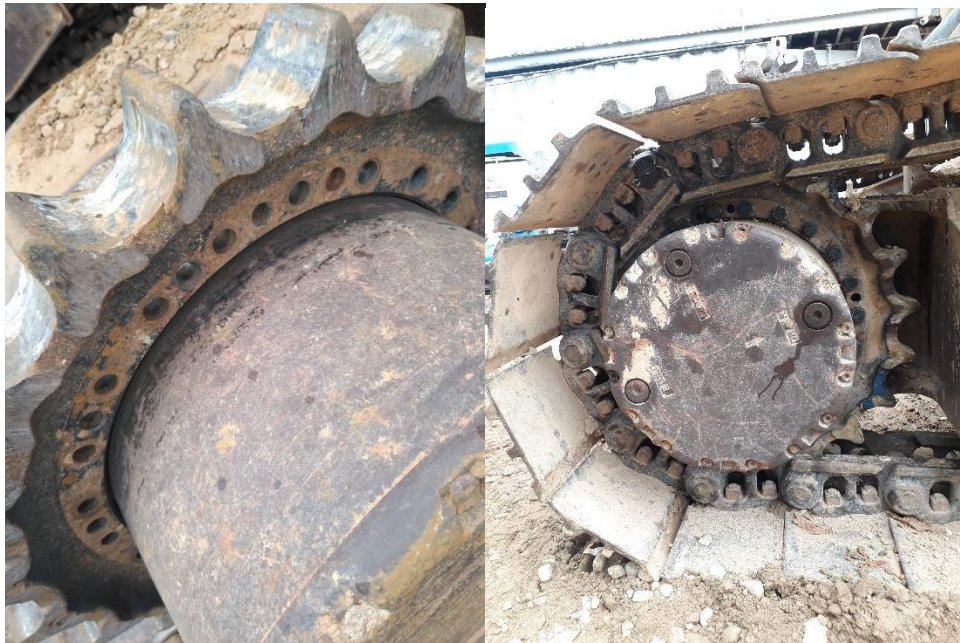
Figura 37. Sprocket de excavadora Kobelco SK210 donde se partieron los tornillos de ajuste al cual se le instaló un nuevo juego de tornillos.
