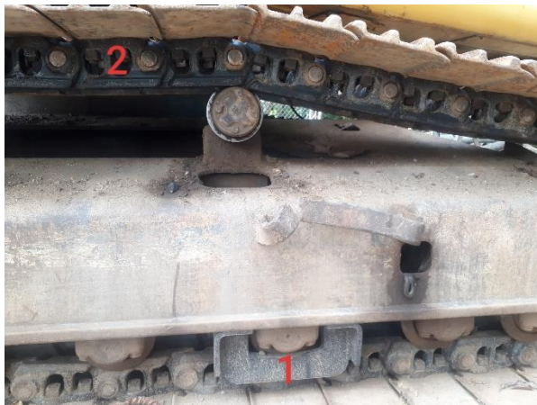
Figura 29, Oruga de excavadora a la cual se le hizo el cambio de guarda carriles (2) y las cadenas (1).
