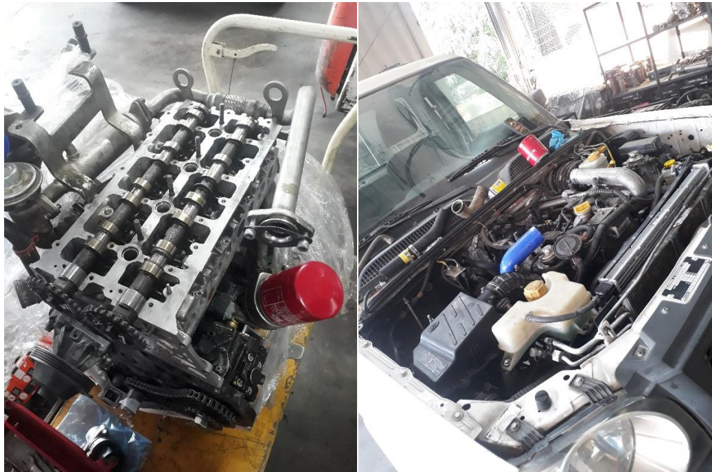
Figura 32. Motor Mahindra pick up 2.2 L en proceso de armado e instalación
