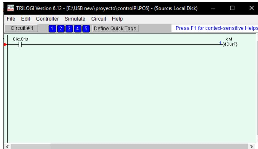
Dentro de los elementos que pueden agregarse en un circuito, está dCusF, el cual es el que permite realizar scripts en un lenguaje de programación propio del software que está basado en C++. La ventana de edición para la programación de PLC se muestra en la Figura 12.
