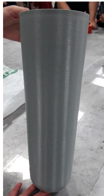
Figura 23. Molde inicial en impresión 3D
