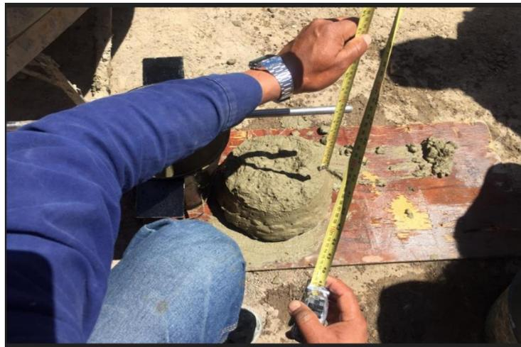
**Imagen 15.** Ensayo slump para concreto.
