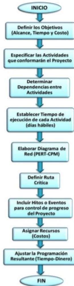
**Figura 5.** Diagrama de flujo para la planificación y programación de obras civiles[5].
