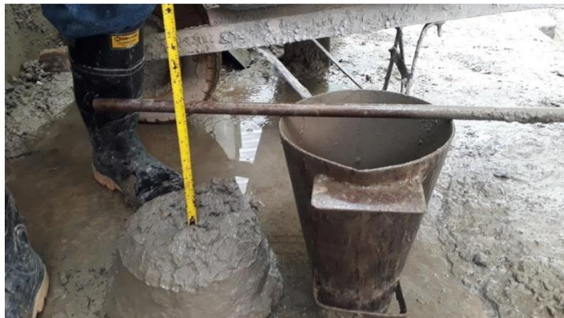
*Figura 26 Prueba de Asentamiento para Concretos Convencionales*
