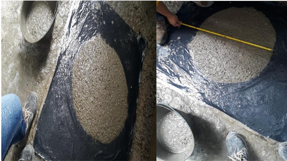
*Figura 25 Prueba de Asentamiento Concretos Autocompactantes*
