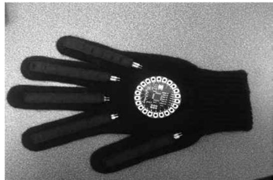
Fig. 7. Guante sin proceso de conexión [Autor]
