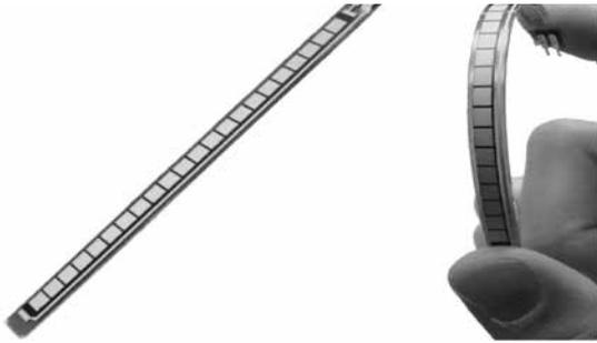
Fig. 1. Sensor de flexión Sparkfun 2.2" [1]
