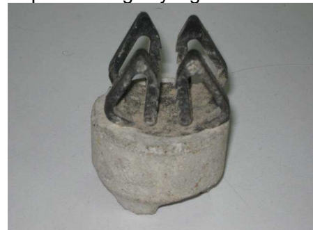
Figuras 30 y 31– Separadores para refuerzo.
