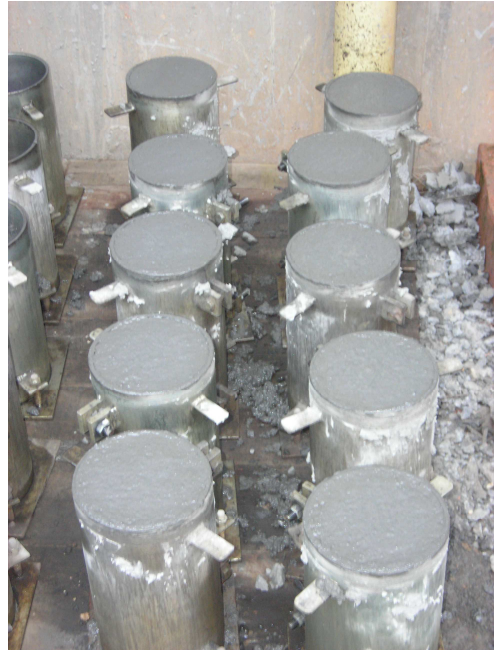
Figura 54– Terminación última capa
