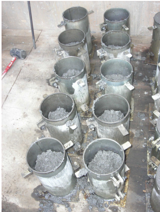
Figura 51– Segunda capa de concreto
