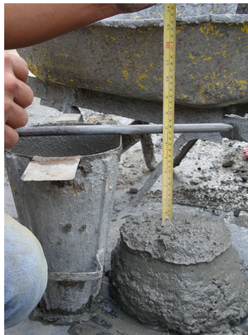
Figura 48– Medición del asentamiento
