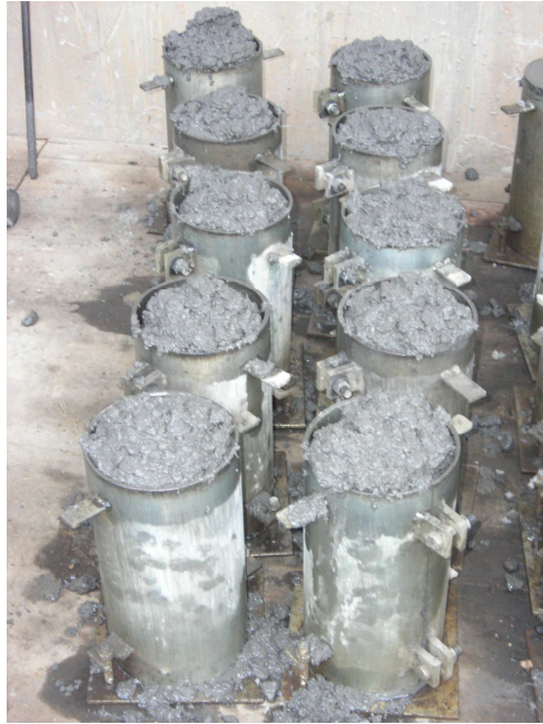
Figura 53– Tercera capa de concreto
