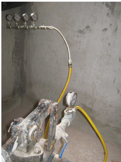
Figura 58–Calibración de manómetro
