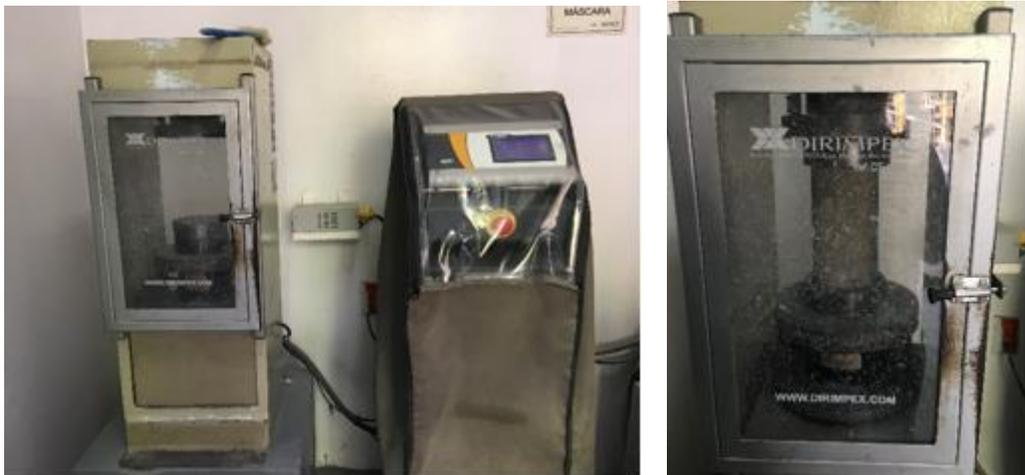
**FIGURA 8. Prenda DIRIMPEX de compresión hidráulica**
