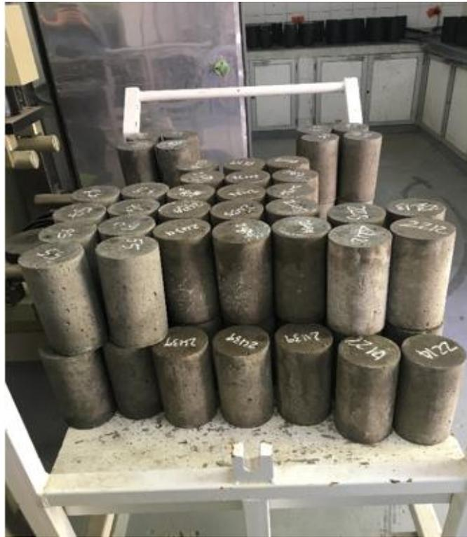
**FIGURA 7. Muestras cilíndricas de concreto**
