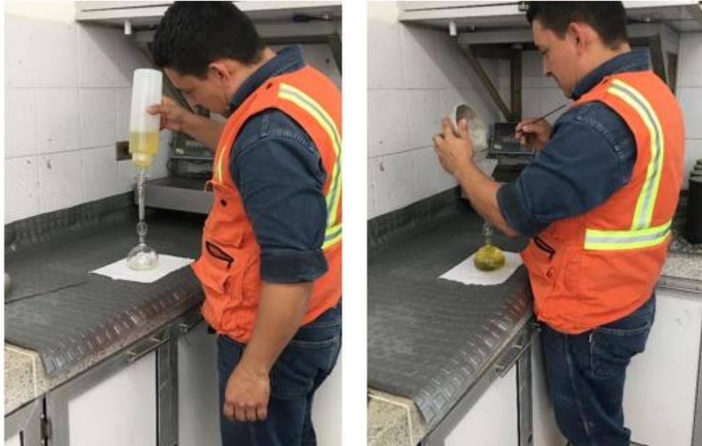
**FIGURA 14. Ensayo de peso específico del cemento**
