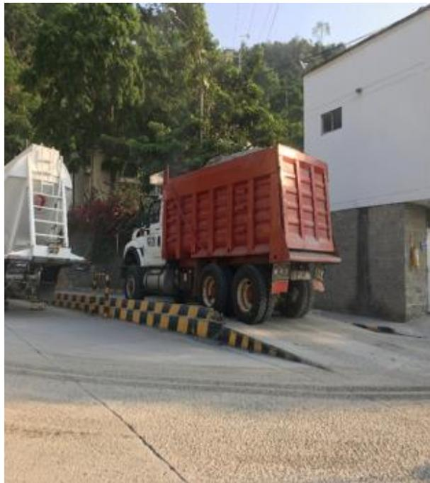
**FIGURA 23. Báscula Camionera calibrada**
