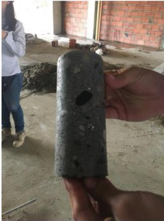
**FIGURA 29. Núcleo de concreto postensado**
