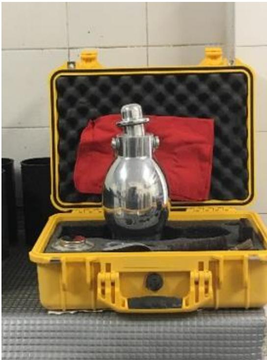
**FIGURA 13. Medidor de humedad tipo Speedy**
