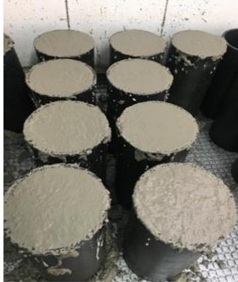
**FIGURA 3. Toma de muestras cilíndricas de concreto**
