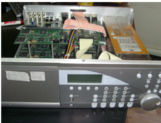
a) Figura 61. Servidor de Video Multicanal marca DOREMI en Mantenimiento. b) Botonera del Panel Frontal del Servidor DOREMI.
