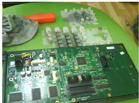
a) Figura 61. Servidor de Video Multicanal marca DOREMI en Mantenimiento. b) Botonera del Panel Frontal del Servidor DOREMI.
