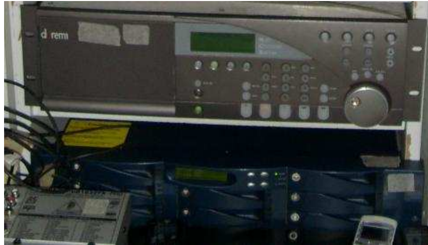
Figura 60. Servidor de Video Multicanal marca DOREMI (Arriba). Banco de Discos Duros (Abajo).
