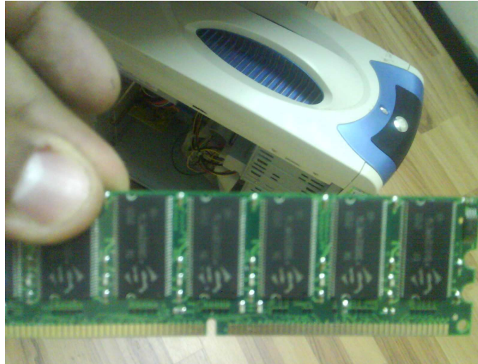
Figura 47. Computador del cuarto de comunicaciones en Mantenimiento. Se observa la memoria Ram del equipo.
