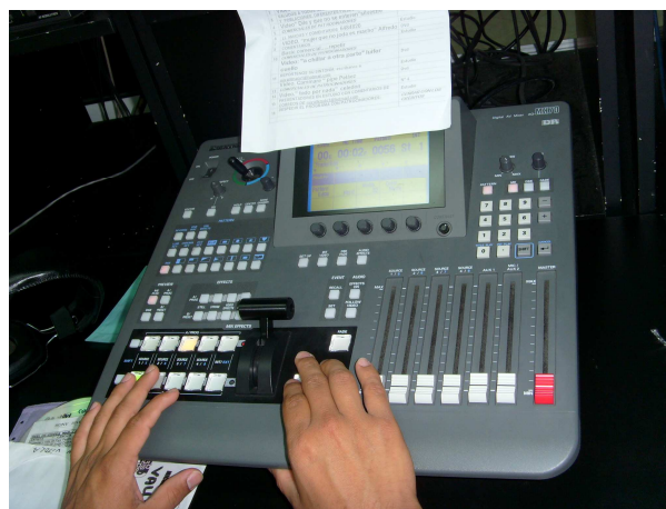
Figura 48. Mixer Digital de Audio y Video (Switcher).
