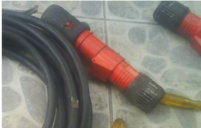
Figura 78. Uniones macho-hembra de 220V a 65A.
