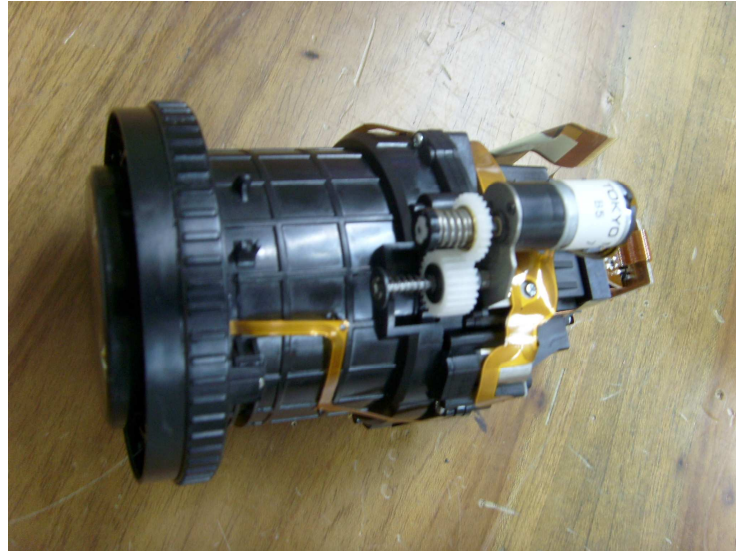
Figura 45. Lente de Cámara de Video Profesional en Mantenimiento.
