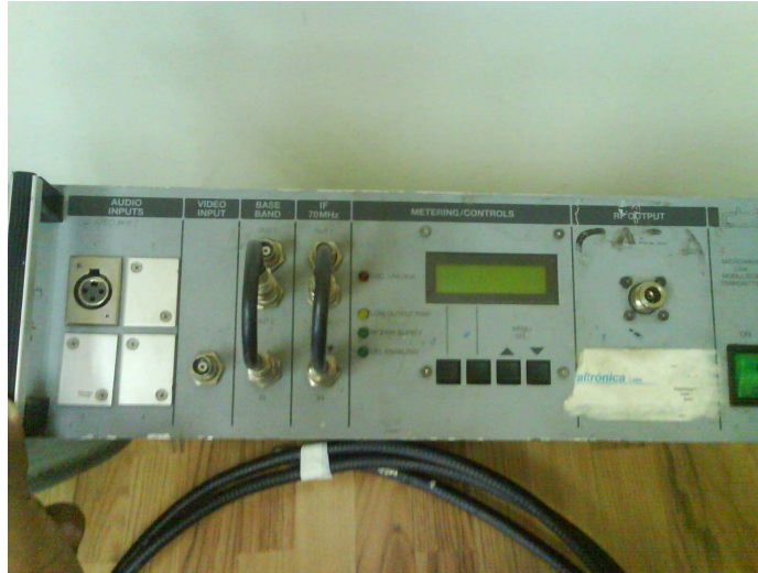
Figura 62. Panel Frontal de un Radio Transmisor de Microondas
