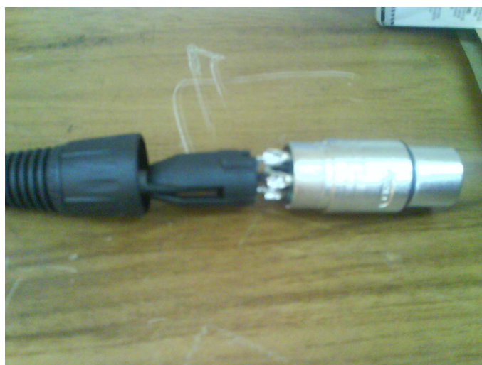
Figura 9. Estructura de un Conector XLR-3 Hembra.
