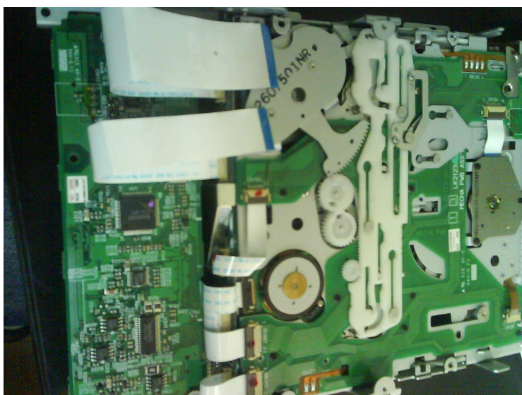
Figura 35. Cassetera Mini DV en Mantenimiento. Parte Mecánica y Engranajes.
