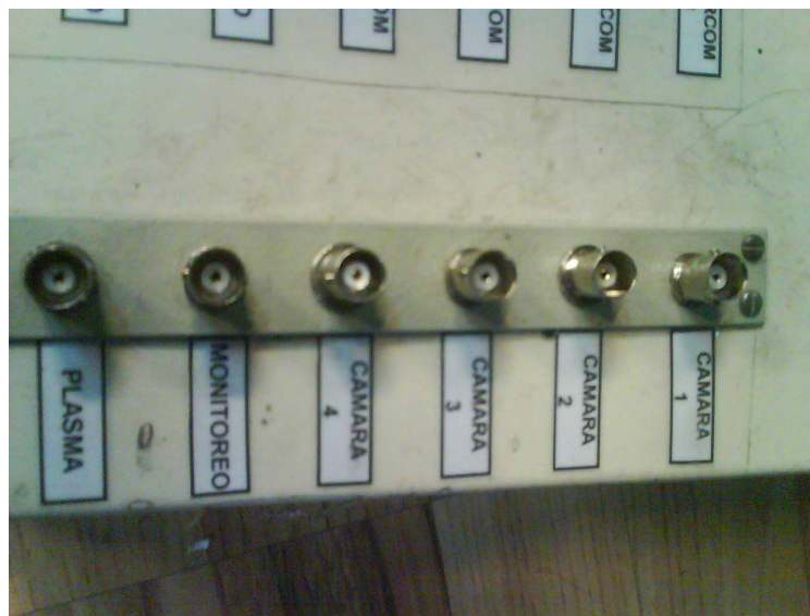
Figura 11. Conectores BNC Hembra.
