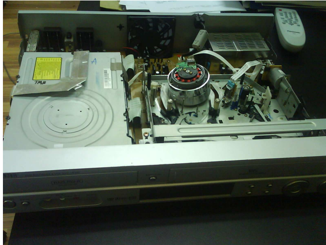
Figura 68. Reproductor de DVD y VHS en Mantenimiento.
