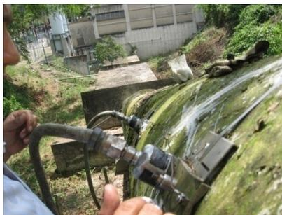
**Figura 14. Medidor de caudal tubo principal bombeo Bosconia**
