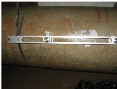
Figura 9. Distancia entre sensores
