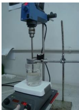
Fig. 1. Montaje experimental para la obtención de la mezcla.
