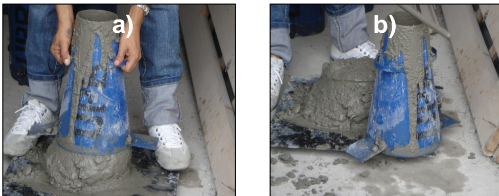
Figura 8. Ensayo de asentamiento a) levantamiento del cono, b) medida del asentamiento de la mezcla
