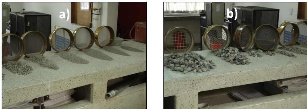
Figura 4. Análisis granulométrico, a) análisis granulométrico realizado al agregado fino, b) análisis granulométrico del agregado grueso
