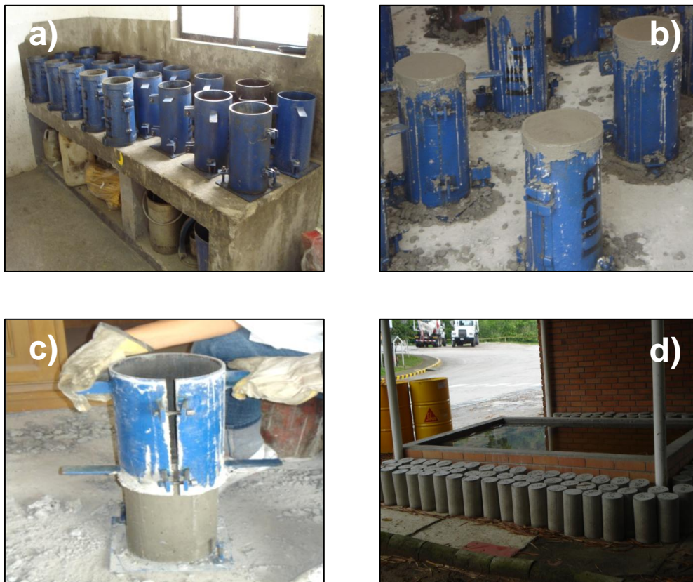
Figura 9. Proceso de elaboración y curado de las muestras de concreto, a)Formaleta lista para elaboración de especímenes, b) Muestras de concreto elaboradas, c) Proceso de desformaleteado de las muestras, d)Tanque de curado de muestras.
