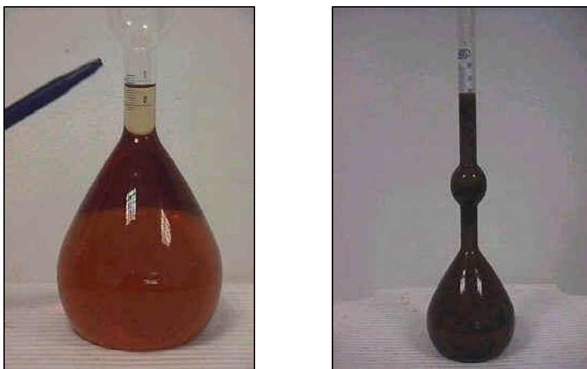
Figura 3. Determinación del peso específico del cemento, a) Lectura del volumen inicial (Kerosene), b) Lectura final del volumen una vez adicionada la masa de cemento
