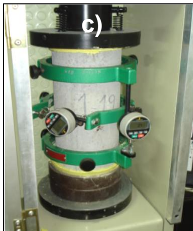
Figura 14. Procedimiento seguido para la determinación de los módulos de elasticidad a) instalación del extensómetro; b) ajuste de los deformímetros; c) colocación del espécimen en la prensa; d) realización del ensayo y registro de datos
