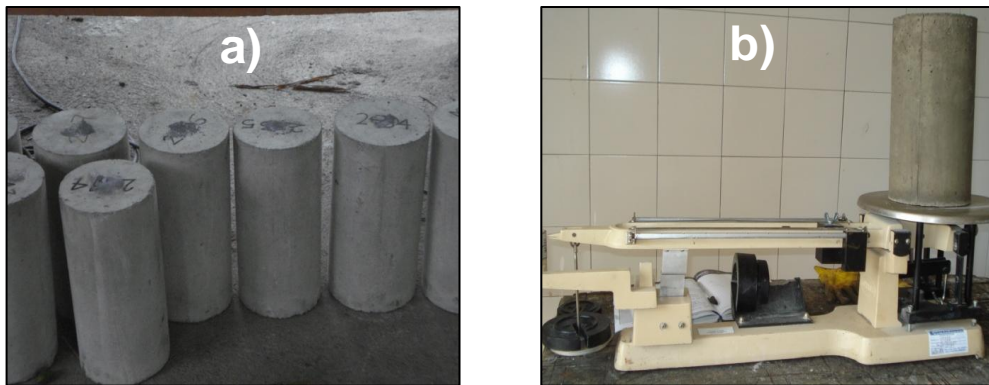
Figura 10. Determinación peso unitario en estado endurecido, a) Muestras en estado seco, b) peso seco de las muestras
