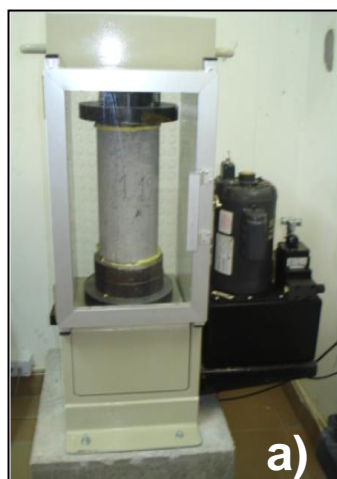
Figura 13. Ensayo Compresión a) Máquina de compresión; b) Tablero digital de carga
