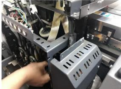
Figura 26. Instalación de cabezales de tinta en una Xenons UV M-180
