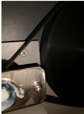
Figura 23. Mecanismo de transmisión mecánica de polea y banda del carro de cabezales de una KingJet 1024i
