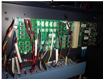
Figura 25. Instalación de las conexiones y cable de datos de una Xenons Dx5-4H
