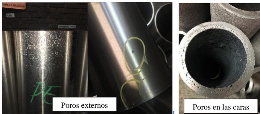
**Ilustración 7.** *Poros en la fundición*
