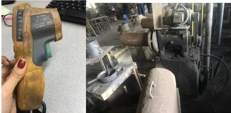
**Ilustración 22.** *Pirómetro / Molde y dispositivo de calentamiento*
