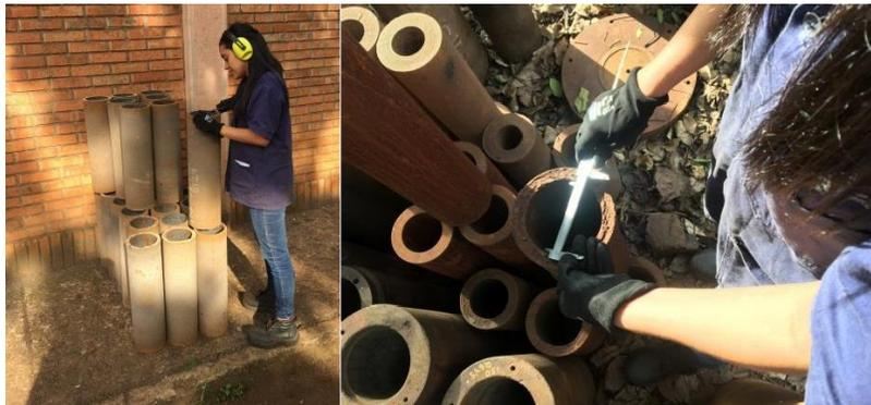
**Ilustración 33.** *Medición de dimensión interior de tubos*
