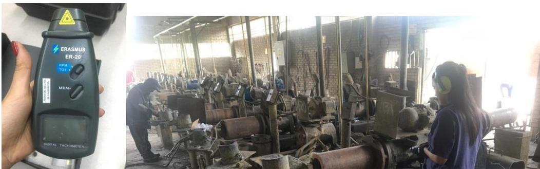
**Ilustración 17.** Tacómetro y toma de prueba de R.P.M centrifuga 096
