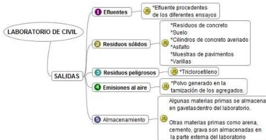
Figura 11. Laboratorio de civil (SALIDAS)
