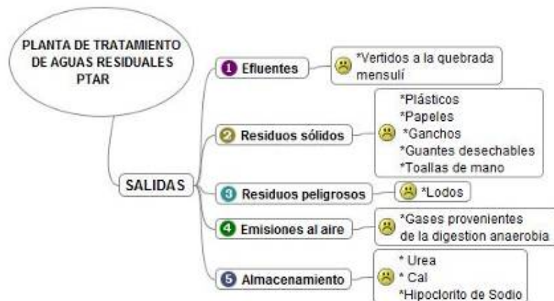
Figura 39. Planta de Tratamiento de Aguas Residuales PTAR (SALIDAS)
